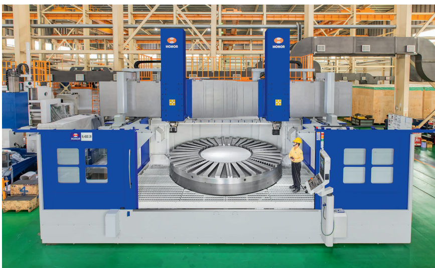
10 Die VL-400C-2R von Honor Seiki ist für das Hartdrehen von Schwenklagern für Windkraftanlagen ausgelegt. Andere Maschinenarten wurden zum Bohren dieser Lager konzipiert, andere zum Spanen von Getriebegehäusen oder Rotorblattlagerkäfigen © Honor Seiki
